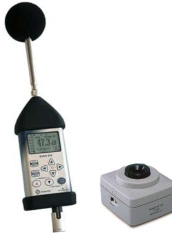
El equipo fue calibrado antes y después de las mediciones según procedimiento interno Amaranto-EA para verificar el correcto funcionamiento de estos y dar validez a las mismas. En la calibración anterior a las mediciones, se obtuvo un valor de 94.0 dBA, y en la posterior se obtuvo un valor de 94.0 dBA.
