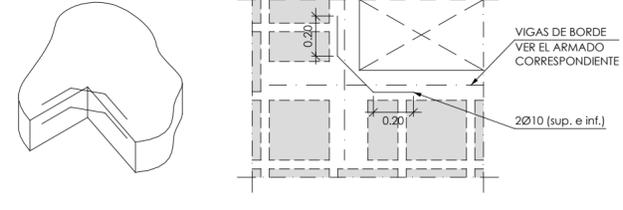
**10** Refuerzo de Nervios a Cortante en Abaco Mediante Espirales e: 1/25
